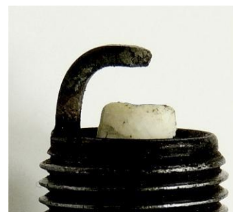
Вид свечи зажигания при превышении предписанного момента затяжки
