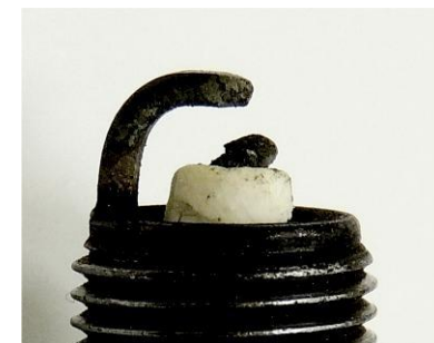
Вид свечи зажигания при превышении предписанного момента затяжки
