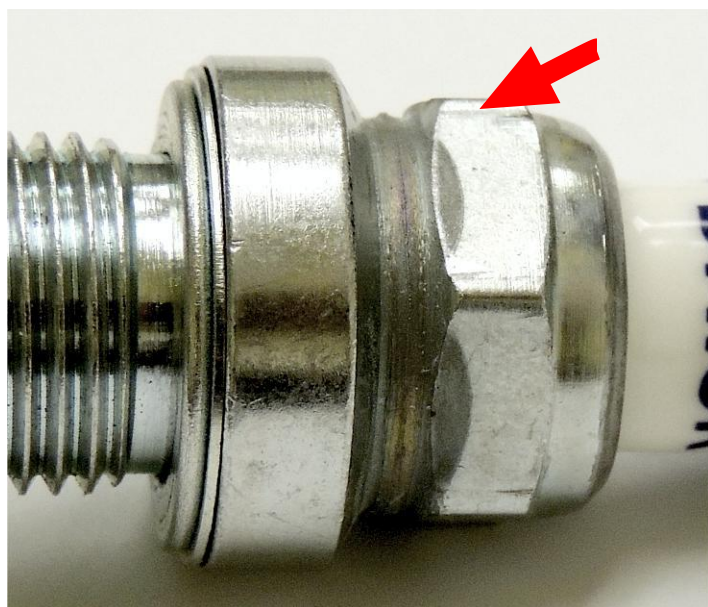
Вид свечи зажигания при применении предписанного момента затяжки
