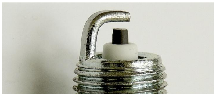
Вид свечи зажигания при применении предписанного момента затяжки
